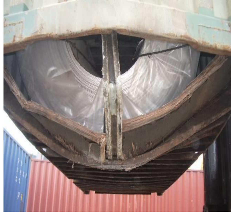
적절하지 못한 Bedding, Lashing, Blocking 으로 인해 발생되어진 완전히 붕괴되어진 컨테이너 하부.
