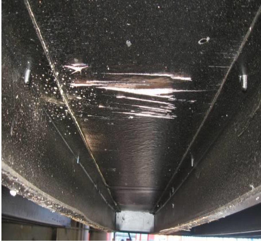
Coil에 의해 집중하중을 받은 CONTAINER 이로 인해 Downward dent X-mbr and Floor cracked DM 발생.
