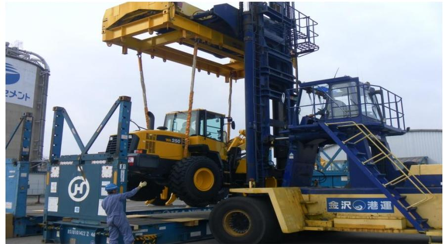
3) 장비를 컨테이너 적재 시 정해진 Lift Point에 Shackle 및 Sling belt를 이용하여 Crane 이나 Reacher Stacker로 장비의 좌,우/전,후 정확한 Balance로 균형있게 적재 하여야 한다.
