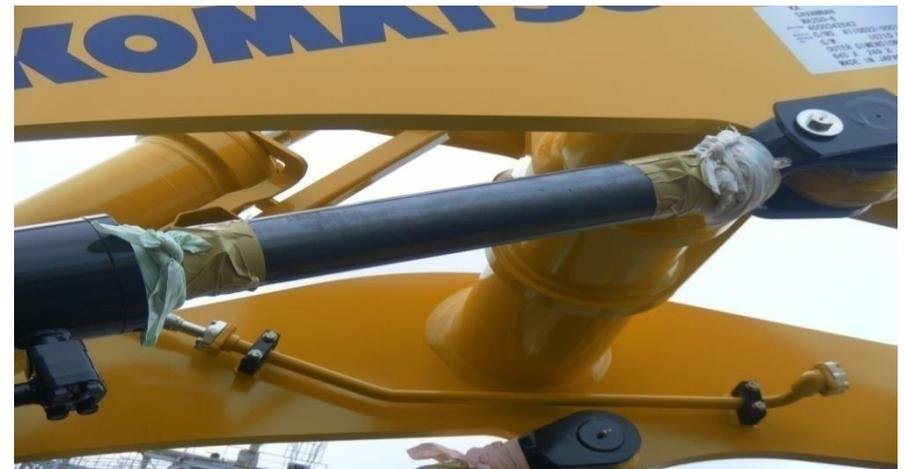
7) 장비의 Lift Cylinder가 내려움을 방지하기 위해 Steel Pipe류를 이용하여 고정작업을 한다. 이때 사용되는 자재는 Pipe(지름8.8cm, 길이57cm를 1/2 잘라 나눔, 고무패드(20 x14.5cm), 보루(부직포), 밴드, 테이프가 사용된다.
