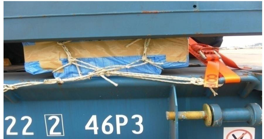
8) 장비의 Accessory부품을 타포린 등으로 포장하여 Serial NO와 동일한 장비에 적재된 컨테이너 후면에 PP Rope를 이용하여 고정시킨다.
